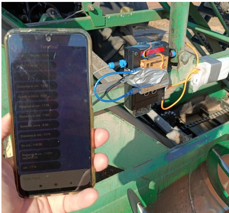
Рисунок 2. Данные о расстоянии до бурта, его высоты и скорости приближения к массиву груза и частоте вращения вала рабочего органа на внешнем демонстрационном устройстве (экране смартфона)
