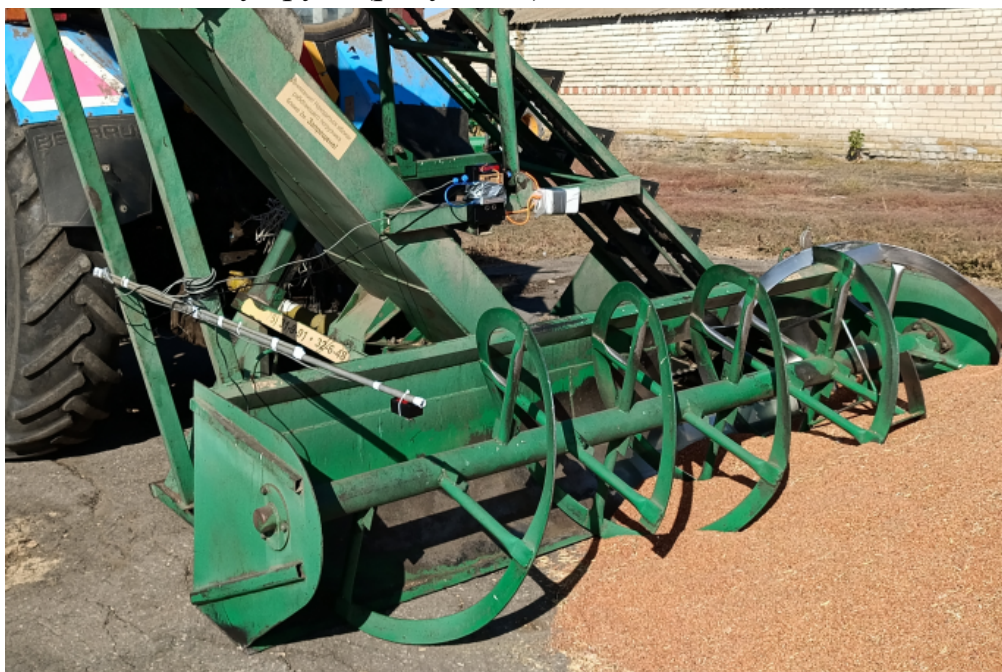
Рисунок 1. Устройство для оптимизации режимов работы погрузчика ПЗН-250
